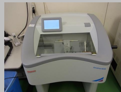
5 組織の凍結薄切標本の作製
