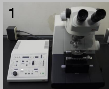
1 透過型電子顕微鏡の 超薄切標本の作製
