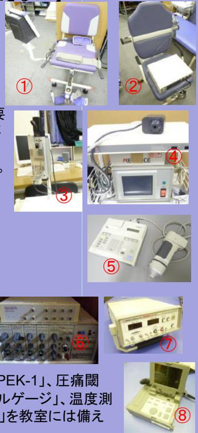
その他: 固さ測定用「PEK-1」、圧痛閾値測定用「プッシュプルゲージ」、温度測定用「サーモビューア」を教室には備えている。
