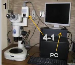
1. 0.75~25倍ズーム観察可能な実体顕微鏡(手動)です。顕微鏡用デジタルカメラが装着されており、パソコンモニター上で動画を観察しながら実体顕微鏡下の顕微解剖が可能です。
