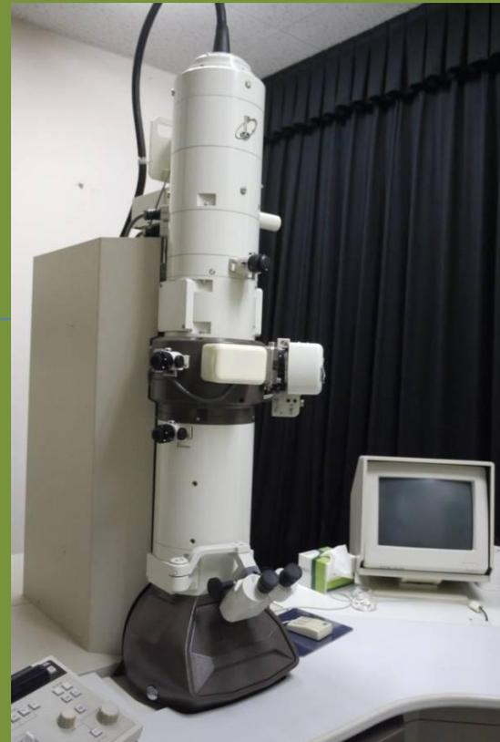
2. 超薄切された標本に電子ビームをあて干渉像を拡大して観察できます。樹脂標本の超薄切装置は、光顕・電顕試料作成室にあります。
