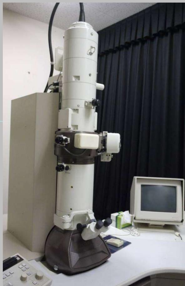
2. 超薄切された標本に電子ビームをあて干渉像を拡大して観察できます。樹脂標本の超薄切装置は、光顕・電顕試料作成室にあります。
