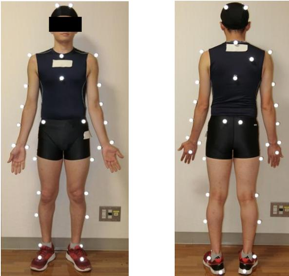
図1 39箇所への反射マーカの貼付
