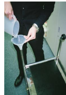
図 3. 支柱に砂利を詰める
