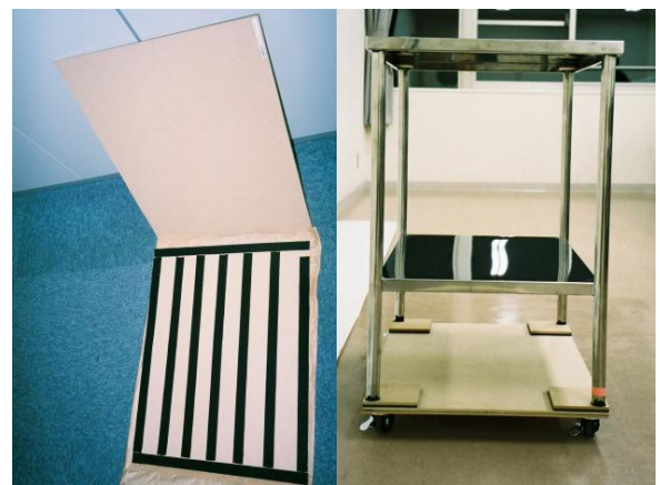
図 4. 製作途中の防振台（左）と防振台にのせたワゴン（右）
